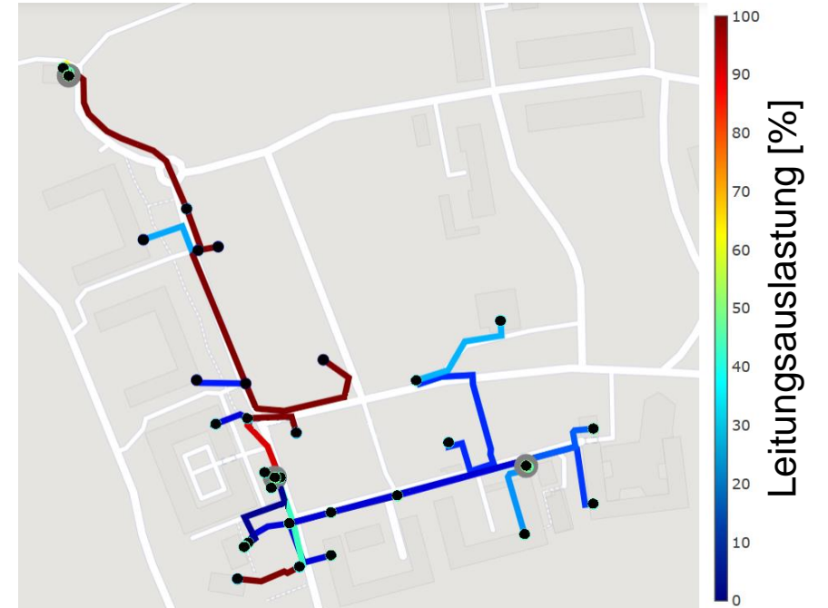
Leitungsauslastung in einem Niederspannungsnetz.
